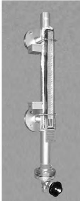
Typ 710.098.0 ausgerüstet mit Flanschschluß, Magnetschalter für MIN und MAX, Kappe, Abbläsventil und Anzeigenleiste 710.AVG3.
