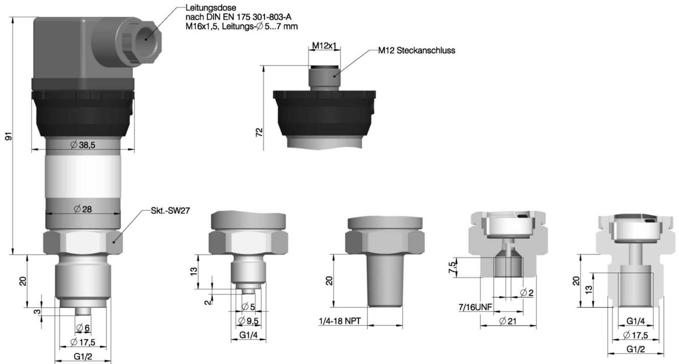
Ausführung mit fast frontbündigem Drucksensor:
